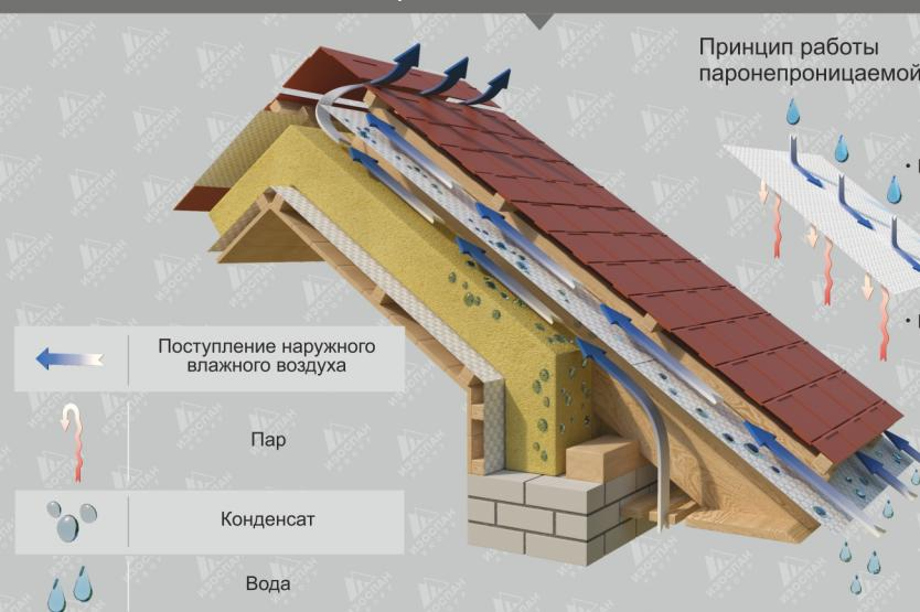
утепленная кровля с использованием паропроницаемой (диффузионной) мембранны
